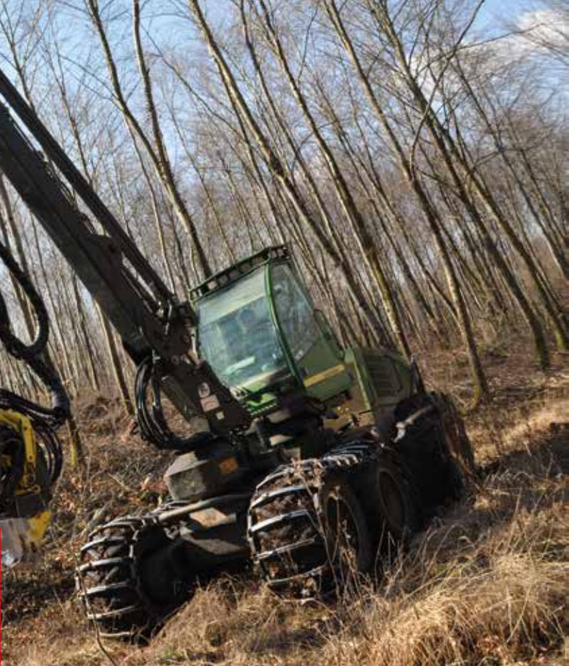
14. L'utilisation de tracks sur les roues des abatteuses se généralise pour protéger les sols.
