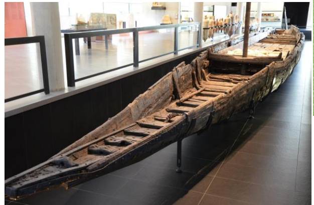
Figure 7. La barge gallo-romaine d'Arles Extraite du Rhône après 2000 ans d'immersion, cette barge de 31 m de long, était surtout faite de bois de chêne (un peu de sapin, épicéa, pin, et frêne pour le mât). L'analyse dendrochronologique a montré que les arbres ont été abattus entre 47 et 49 de notre ère, laissant supposer la construction de la barge vers 50.
