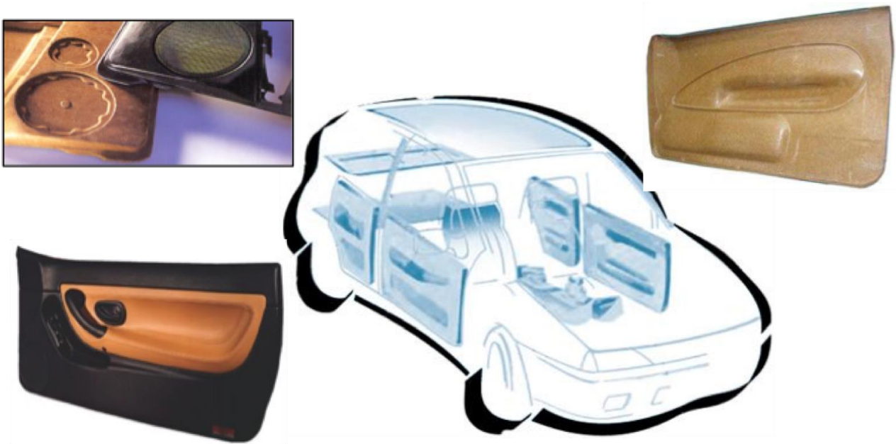
Figure 8. Parties de véhicule en fibre de bois moulées
