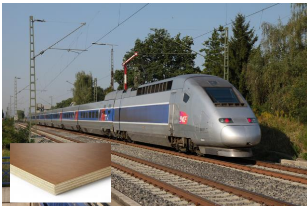
Figure 9. Plancher du TGV en contreplaqué multiplis
