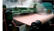
Figure 9. Le déroulage. Paramètre important la position de la barre d'appui par rapport au couteau
