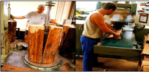
Figure 10. Des merrains aux douelles
