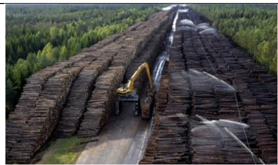
Fig. 2 : après la tempête Gudrun en Suède (2005), piles de tempête Klaus de janvier 2009, (13 m de haut, 1 km de long) stockées sous aspersion sur un aérodrome désaffecté, totalisant 1 M m 3 (Photo Ola Nilsson)
