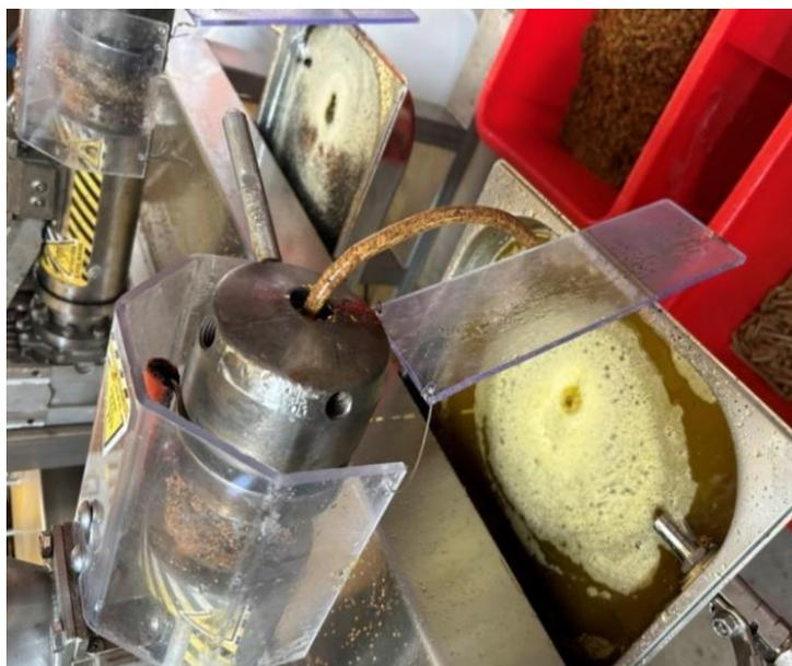
Figure 4 : extraction à froid d'huile de cameline par une bi-vis (photo : Alain Bonjean)
