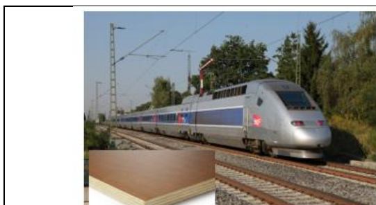
Figure 4 : plancher de TGV en contreplaqué multi-plis
