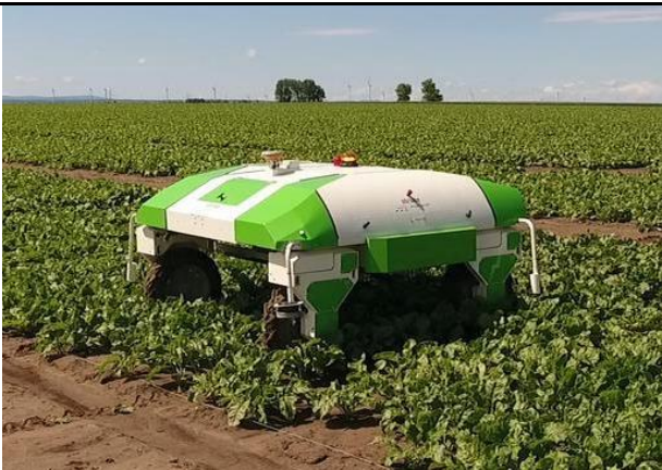
robot Naio de binage des betteraves sucrières
