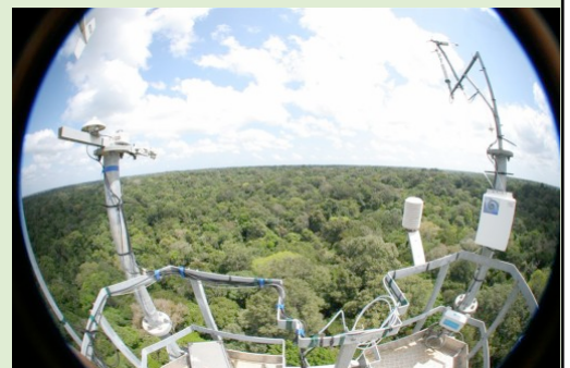
Figure 3. Gyaflux : des capteurs placés en haut d'une tour de 55 m au-dessus de la canopée mesurent les échanges hydriques et gazeux entre la forêt et l'atmosphère - Photo Ecofog
