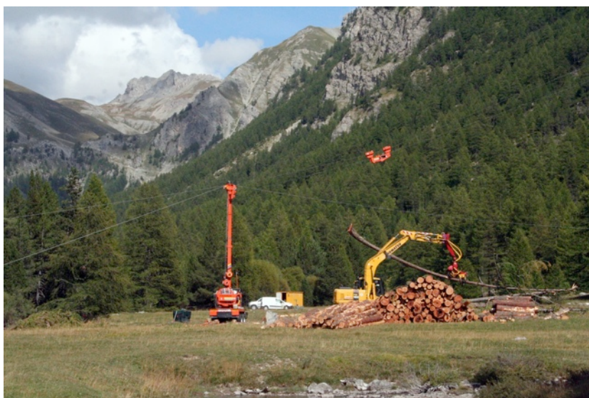
Figure 6. Exploitation par câble-mât en montagne - Source : FCBA
