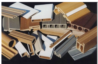
Figure 13. : exemples de bois composites (bois-plastique extrudé) pour la menuiserie
