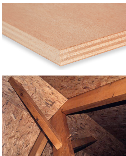
Figure 2. Panneau de contreplaqué (en haut) et panneau OSB (en bas)
