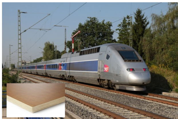
Figure 9. Plancher du TGV en contreplaqué multiplis
