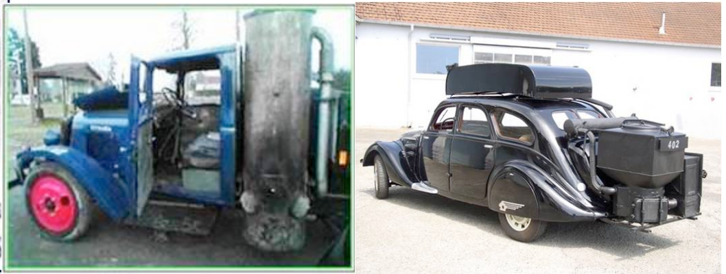
Figure 1. Quelques gazogènes sur véhicules
