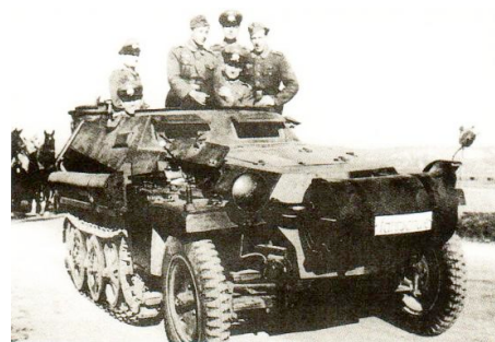
Figure 1. Blindé allemand équipé d'un gazogène à bois au cours de la 2 e guerre mondiale - Source
