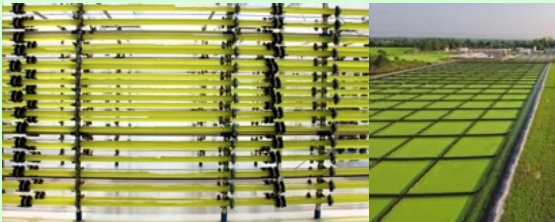
Différents systèmes de culture des micro-algues (dans des tubes éclairés à gauche et en bassins à droite).
