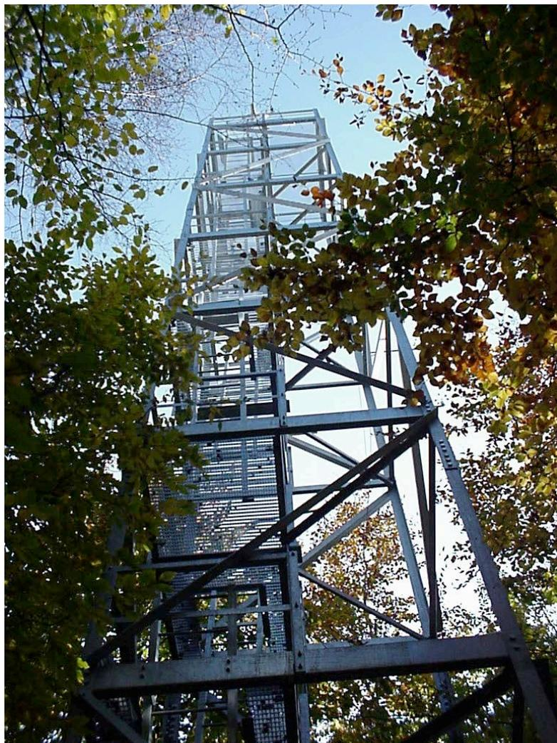
**Figure 1 - Tour à flux en forêt de Hesse (Moselle).** Le dispositif de Hesse fait partie du réseau national SOERE (Systèmes d'Observation et d'Expérimentation, sur le long terme, pour la Recherche en Environnement), et du sous-réseau *F-ORE-T* (Fonctionnement des écosystèmes forestiers). Il mesure en continu les flux de CO<sub>2</sub> et d'H<sub>2</sub>O au dessus d'une hêtraie de plaine, pour évaluer et modéliser les bilans de carbone et d'eau (photo INRA).
