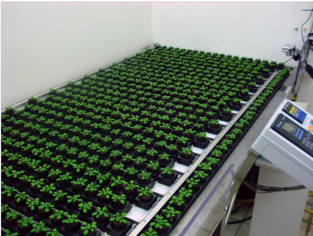
Figure 3 Un des 2 robots ' Phenoscope ' de l'IJPB, prenant en charge 735 plantes individuelles, âgées d'environ 25 jours sur cette photo.
