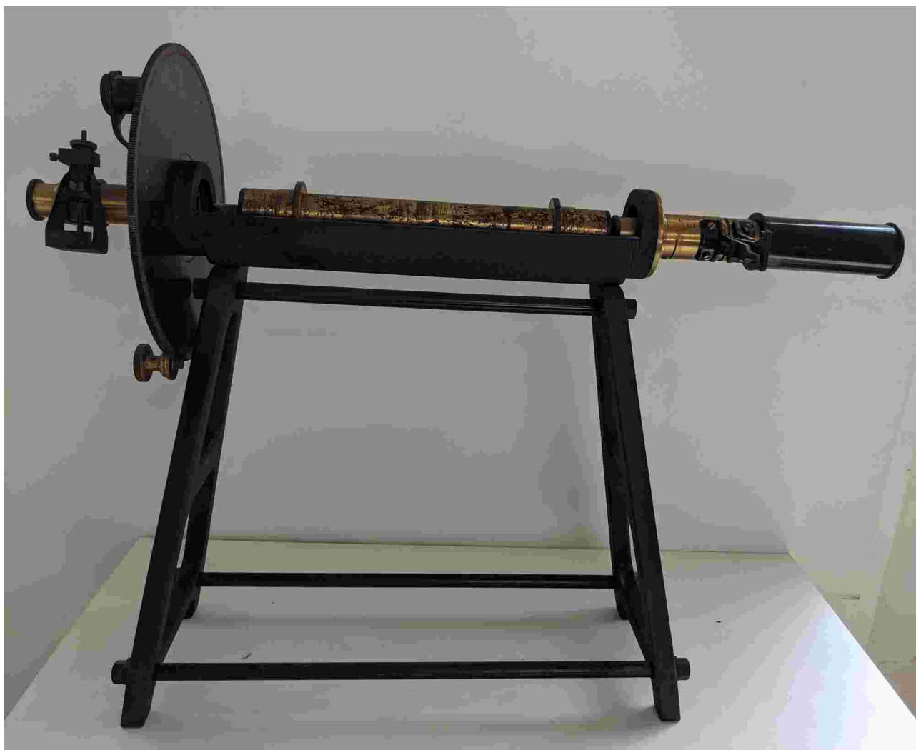
Figure 7. Un polarimètre à prisme pour l'étude des liquides. L'observateur regarde, dans l'oculaire à gauche de l'appareil, la lumière qui est polarisée par l'objectif à droite. Le cylindre central (placé dans un berceau) contient la solution à analyser. On tourne un filtre polarisant solidaire du disque (gradué) jusqu'à ce que plus aucune lumière n'arrive à l'œil (crédit H. This).
