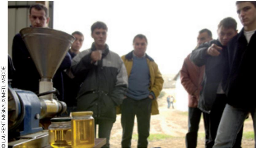
Pressage de colza pour la fabrication de carburant sur les moteurs agricoles et de tourteaux pour l'alimentation du bétail - Laval (53)
