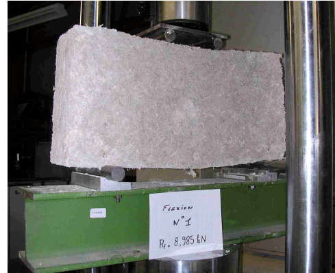
Fig. 4 : Essais de résistance à la compression simple à g. et échantillon sollicité en flexion à dr.
