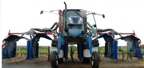
Panneaux récupérateurs (Source Berthoud)
